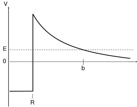
Hat das  $\alpha$ -Teilchen im Kern bereits eine Energie  $E > 0$ , kann es durch die Barriere tunneln und den Kern verlassen. Die Barriere ist nicht rechteckig, und das Potentialniveau außerhalb ist auch nicht auf beiden Seiten dasselbe. Bei vorgegebenem  $E$  lässt sich zunächst der Ort (Radius)  $b$  bestimmen, wo der Austritt aus der Barriere erfolgt, und somit die gesehene Barrierendicke.
