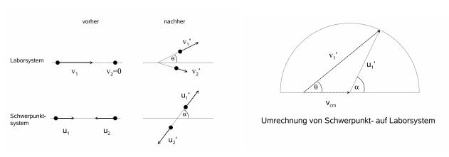
b) Betrachten Sie nun den Fall, dass Kugel 2 nicht festgehalten wird. Zeigen Sie unter Ausnutzung der Impuls- und Energieerhaltung, dass zwischen dem Streuwinkel im Laborsystem  $\vartheta$  und dem Streuwinkel im Schwerpunktsystem  $\alpha$  folgender Zusammenhang gilt:
