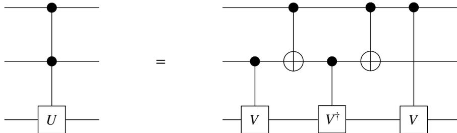
b) Durch welches  $V$  kann auf diese Weise das Toffoli-Gatter erzeugt werden?
